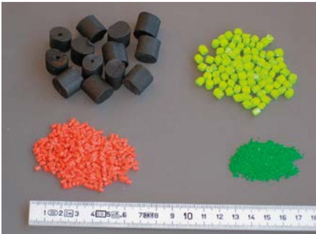
Abb. 2 - Sand-/Kies-Tracer: links - Tracer in vier verschiedenen Korngrößen, teils beschichtet und eingefärbt, teils im Rohzustand (schwarz); rechts - Ausbringung der Tracer entlang einer Startstrecke in der Station STEC.
