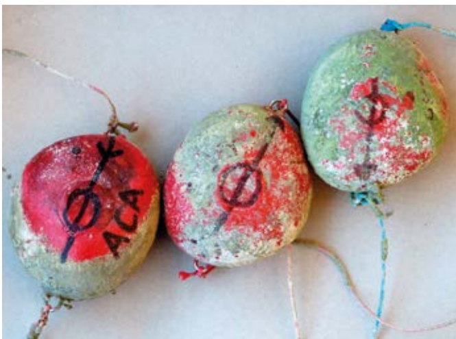
Abb. 8 - Sohltransport: links - geborgene Tracer-Gerölle aus der Station UUHL nach 34 monatiger Expositionszeit; die Oberseiten sind mit einer Kalkkruste überzogen, dennoch sind der Code und die Markierungen deutlich zu erkennen; rechts - im Sediment eingebettete Tracer-Gerölle in der Station KRAH nach 34 monatiger Expositionszeit, nur noch die Markierungsschnüre sind zu erkennen, links daneben das Massband zur Positionseinmessung. Foto W. Hohl, LAD Bad.-Württ.
