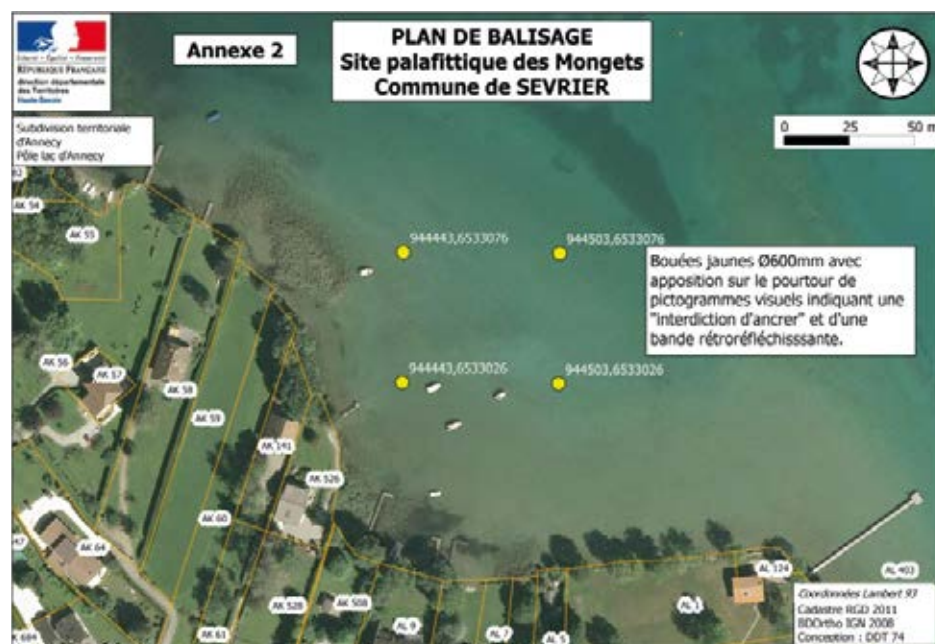
Fig. 6 - Sévrier/Les Mongets (lac d'Annecy). Compte tenu de son implantation (secteur fréquenté par les plaisanciers, faible profondeur, superficie réduite, nature des fonds), l'emprise de l'habitat Bronze ancien a été délimitée par des bouées d'interdiction de mouillage. Pour éviter qu'une chaîne dormante repose sur le fond et provoque une érosion mécanique circulaire, les bouées sont fixées avec un flotteur intermédiaire, sur des ancres permanentes hélicoïdales. © Document DDT 74, ST Annecy, pôle lac, 2011.
