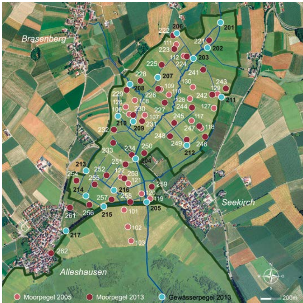
Abb. 10 - Ein dichtes Netz hydrologischer Messstellen im nördlichen Federseeried stellt die Basis für das Monitoring und gegebenenfalls auch Nachsteuerungsmaßnahmen dar. Grafik NABU-Naturschutzzentrum Federsee und A. Kalkowski.
