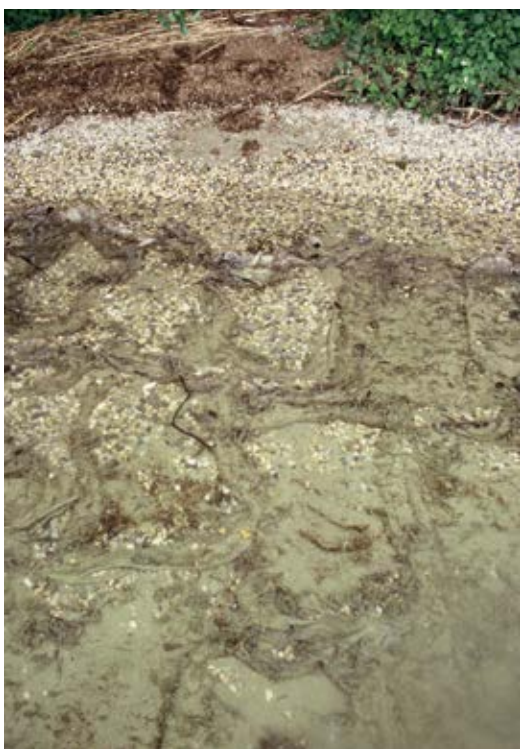
Fig. 5 - Font FR. Sacs de graviers éventrés, 16 ans après leur mise en place. Cliché Denis Ramseyer, 2008.
