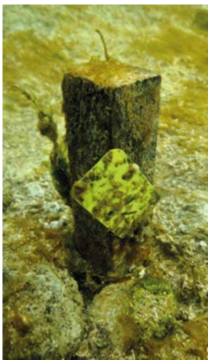
Abb. 15 - Eschenz-Öhningen, OrkopfStiegener Enge, Erosionsmarker (Holzpflock) zum Ablesen des Abtrages. Foto AATG, M. Schnyder.
