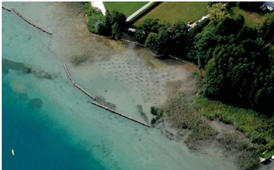
Fig. 13 - Vue aérienne d'un site restauré dans le secteur du « Sentier des roselières » à Saint-Jorioz, sur la rive occidentale du lac d'Annecy, avec des ouvrages anti-houle et des plantations dans la zone protégée. © Le Taillefer Production.
