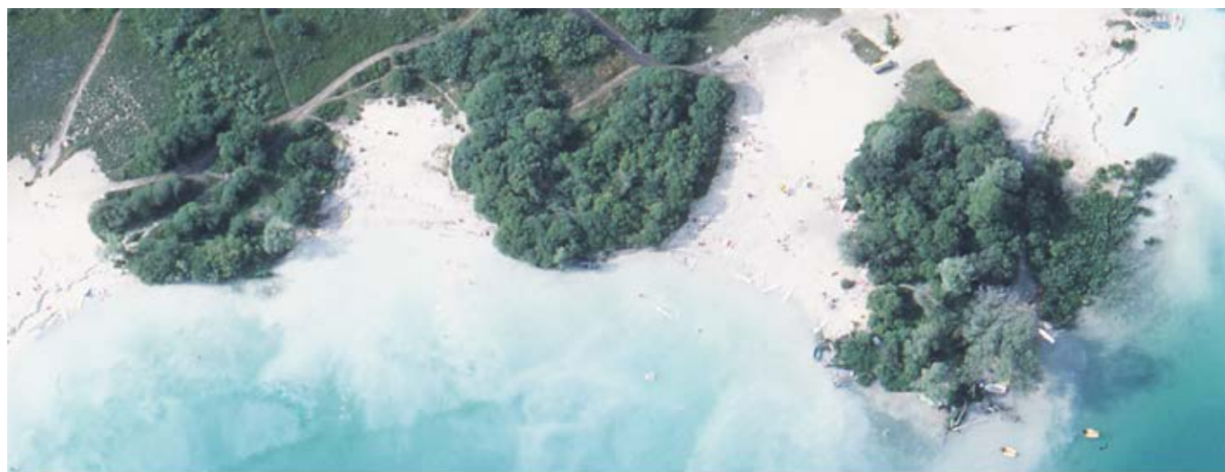
Fig. 4 - En 1995, la pose de géotextiles biodégradables et la plantation de végétaux a permis de freiner, en partie, l'érosion régressive. Photo P. Pétrequin.
