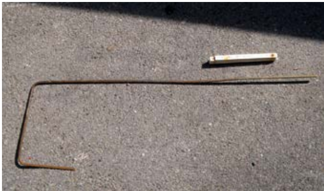
Abb. 4 - U-förmig gebogene Spezialarmier zur Befestigung der Geotextilbahnen am Seegrund. Foto LAD, J. Köninger.
