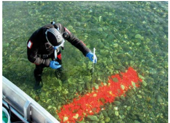
Abb. 2 - Sand-/Kies-Tracer: links - Tracer in vier verschiedenen Korngrößen, teils beschichtet und eingefärbt, teils im Rohzustand (schwarz); rechts - Ausbringung der Tracer entlang einer Startstrecke in der Station STEC.
