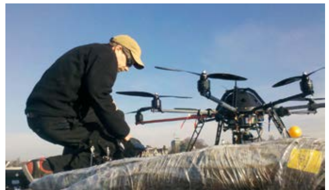
Abb. 15 - Konstanz-Frauenpfahl, Einsatz eines Oktokopters zur Dokumentation und Vermessung des prähistorischen Pfahlfeldes. Im Vordergrund ein vollständig entnommener spätbronzezeitlicher Pfahl. Foto LAD, M. Mainberger.
