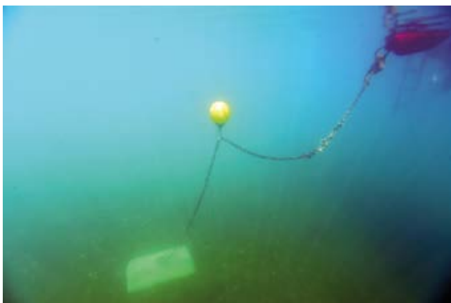
Abb. 7 - Test des denkmalgerechten Bojensystems mit Zwischenboje auf intaktem Seegrund. Foto Kuratorium Pfahlbauten, H. Pohl.
