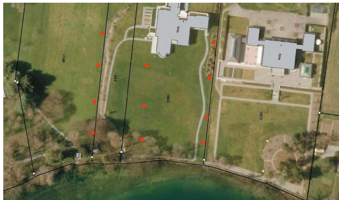
Fig. 6 - Situation et distribution des piézomètres à Zoug-Sumpf. Le réseau d'observation du niveau de la nappe phréatique comporte 11 piézomètres distants de 50 à 100 m sur une surface de 23 000 m 2 .
