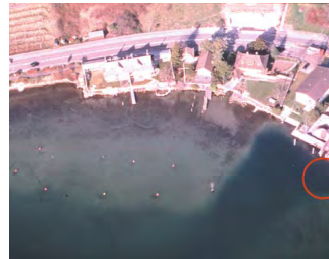
Fig. 12 - Meilen-Im Grund ZH, rive droite du lac de Zurich. Prise de vue aérienne d'une station de chargement de gravier. Outre le corridor d'accès creusé anciennement, on note une zone excavée qui n'existait pas encore sur les prises de vue antérieures.
