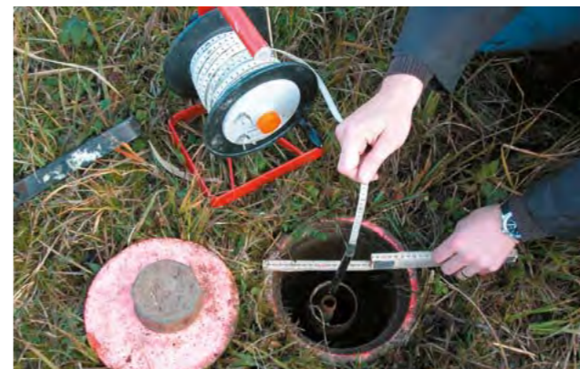
Fig. 4 - Contrôle à Zoug-Sumpf. Pour effectuer les mesures, on insère une sonde fixée à l'extrémité d'un ruban métrique à l'intérieur du tube. Un signal acoustique retentit et un voyant lumineux s'allume dès que la sonde touche la surface de l'eau, dont on peut ainsi déterminer le niveau.
