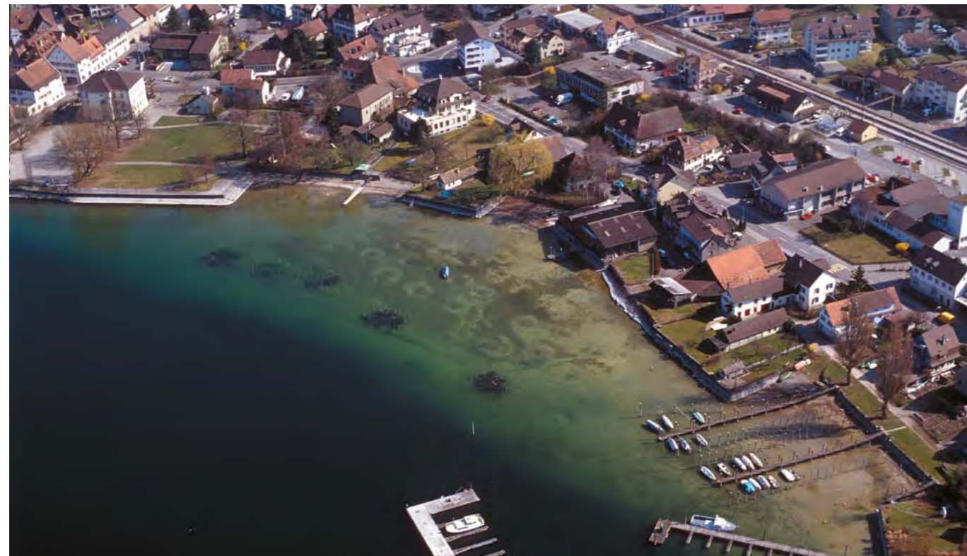
Fig. 4 - Le site de Steckborn, vue du Nord-Ouest. On reconnaît les emplacements où les bateaux mouillent. Les chaînes d'amarrage creusent le fond du lac et créent des cercles blancs vus d'avion.
