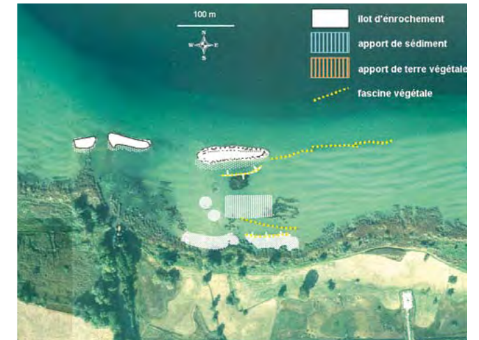
Fig. 3 - Chantier réalisé au sud du lac du Bourget : vue en plan.
